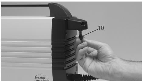
Das andere Schlauchende mit dem Ofen verbinden. Bitte prüfen Sie, ob der Schlauch einwandfrei aufgesteckt ist.
